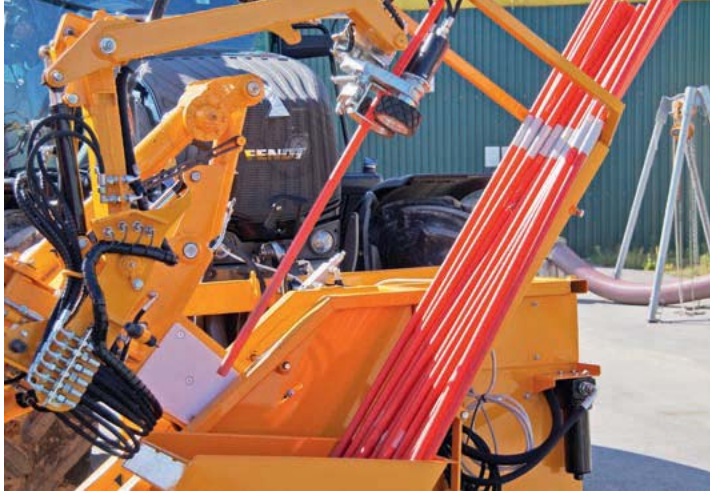
Der Greifarm fasst jeden einzelnen Schneeleitstab.
