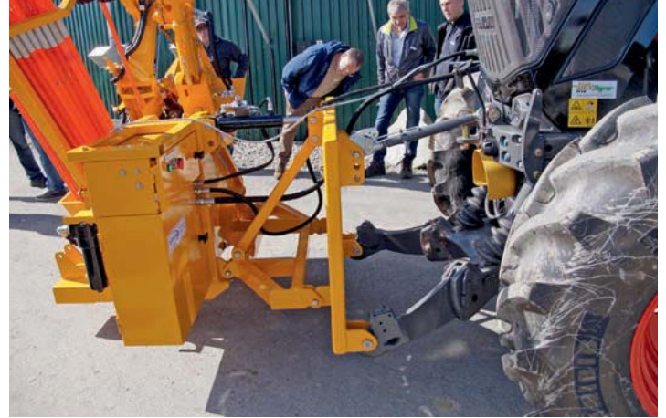
Zur Montage des Anbaugeräts genügen eine Halterung für Schneepflüge, eine 12/24 V-Bordsteckdose und ein 40 l/140-bar-Hydraulikanschluss.
