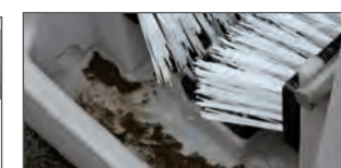
Bac de récupération des eaux usées
