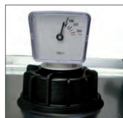
Jauge de niveau à cadran
