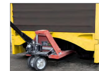
Passage de fourches pour chariot élévateur ou transpalette (manutention à vide)
