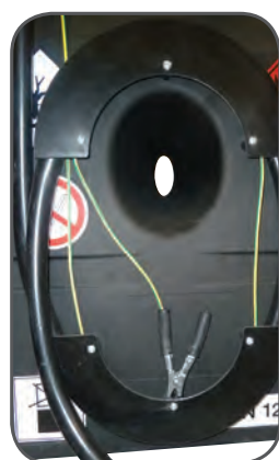
Paroi antirouillis et système de rangement du flexible
