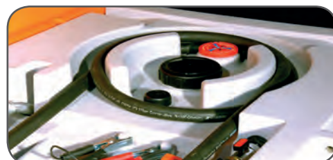
Enrouleur intégré pour 4 m de flexible
