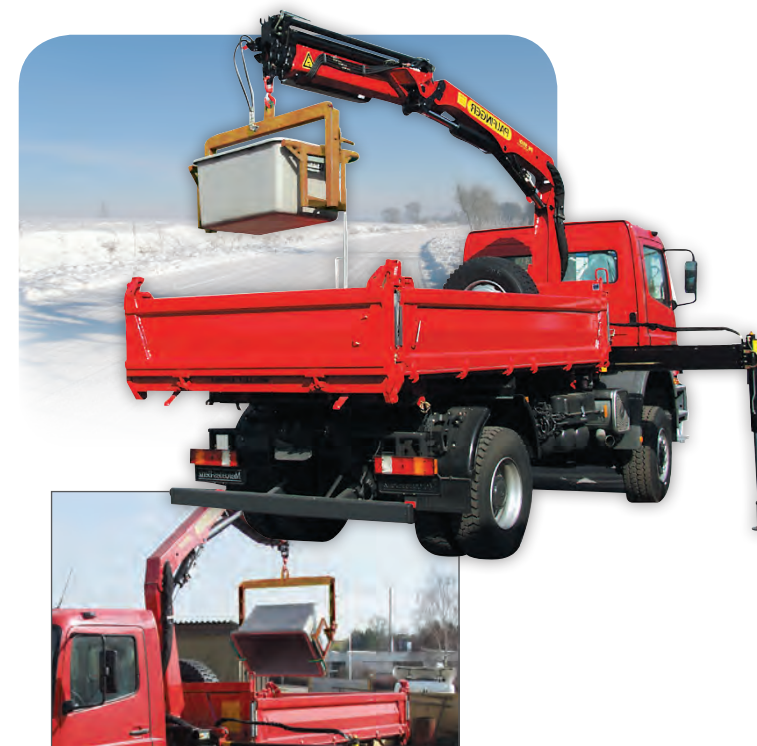
Bascule du bac à sel pour vider le contenu
