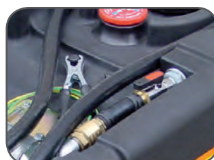
Vanne coupe-circuit et liaison équipotentielle
