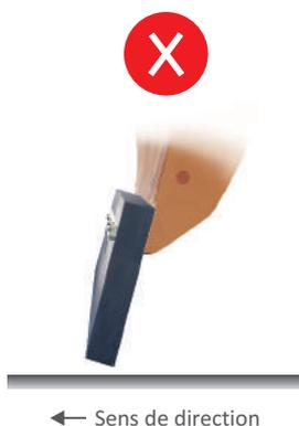
La pente positive du chasse-neige a pour conséquence qu'une lame droite en caoutchouc ou en polyuréthane soit également positif sur la route. Votre déneigement sera inconfortable et moins efficace.
