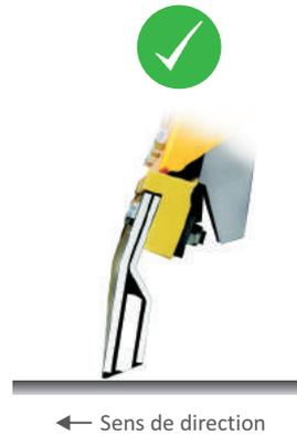
Si le déneigement est donc trop aggressive, les lames inclinées peuvent contrer l'angle d'attaque positif et réduire l'agressivité.
