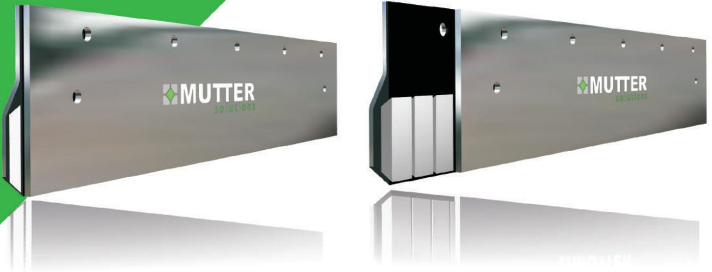
La lame MK est une lame composite. Fabriquée d'un acier spéciale d'une dureté de 450 HB et caoutchouc ainsi que céramique. Elle a été développée pour les applications difficiles.
