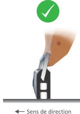
L'angle d'attaque positif du chasse-neige est compensé par la lame MUTTER incliné. Comme résultat, la lame est à un angle idéal de 90° par rapport à la route.
