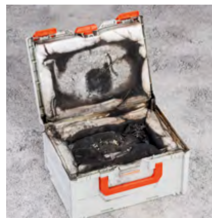
Erfolgreicher Brandversuch: die CEMO Brandschutzbox hält.
